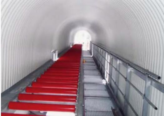
Les capots de passerelles permettent de sécurisés totalement les produits transportés. Ceux-ci n'ont aucun contact avec l'extérieur.
