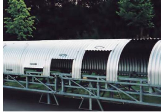
Chaque capot peut être ouvert des 2 côtés, sans nécessité d'ajouter une structure porteuse pour les capots.
