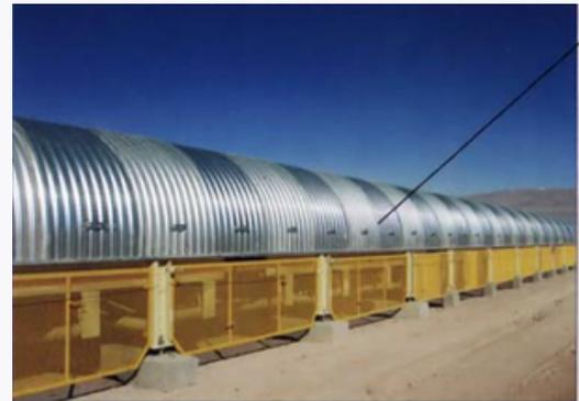
Nos clients sont amenés à utiliser des trappes d'ouverture afin d'inspecter leurs transporteurs. Voici donc un capot constitué d'une poignée solide de chaque côté. Il est également équipé de fixations rapides à installer, poser et retirer afin d'obtenir un gain de temps maximum.
